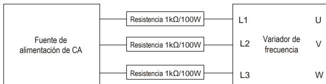
El dispositivo de control de la fuente de alimentación de CC se muestra en la figura siguiente:
