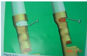
Contactor no calificado
